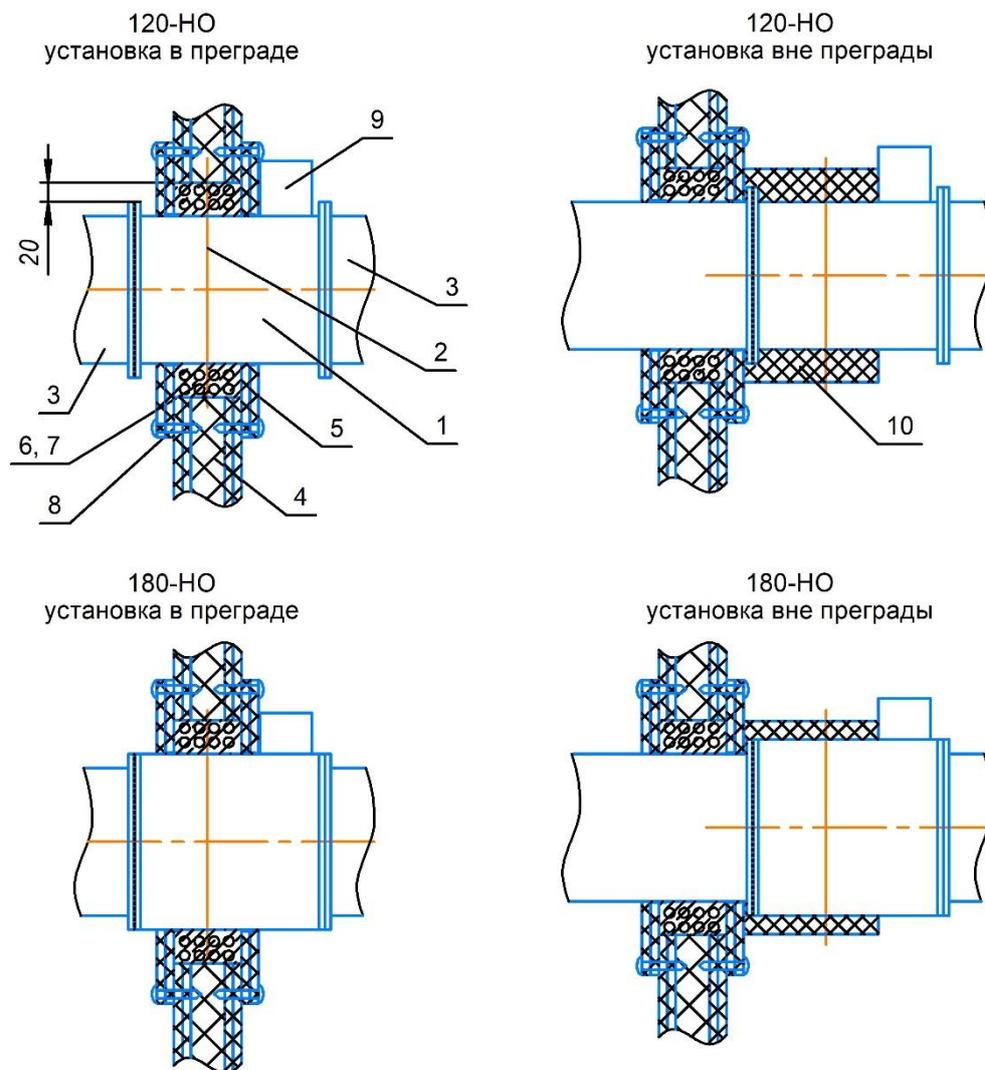
1 - клапан; 2 - ось заслонки; 3 - воздуховоды; 4 – легкая ограждающая строительная конструкция; 5 – огне-влагостойкий гипсокартон; 6-облицовка проема перфорированным железом; 7-цементно-песчаная смесь; 8 – самонарезные винты; 9- защитный кожух; 10-наружное огнезащитное покрытие.
