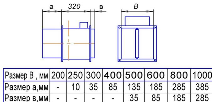
Рис.3. Размеры вылета заслонки в открытом положении за пределы клапана исполнений НЗ-АхВ
